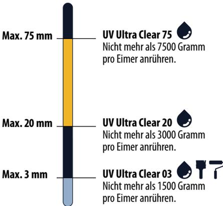
Achtung: Die maximale Schichtdicke ist ein Hinweis, um ein Übergießen zu vermeiden, der bei 20° C gilt. Liegt die Temperatur über 20° C, können Sie weniger als die angegebene Schichtdicke gießen. Beispiel: Liegt die Verarbeitungstemperatur bei etwa 28° C, halbiert sich die maximale Schichtdicke. Das müssen Sie bei der Bearbeitung großer Projekte berücksichtigen.
